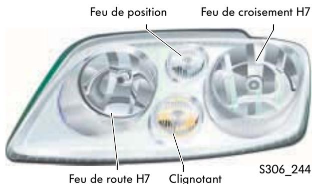
Le projecteur bi-xénon se compose d'une ampoule à décharge pour les feux de croisement et de route et d'une ampoule H7 pour l'amplification des feux de route. L'ampoule H7 sert aux appels de phare. Clignotant et feu de position sont disposés comme dans le cas du projecteur de série.
