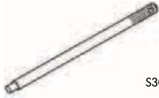
S306_241 | Mandrin de réglage pour montage de la douille de la boîte mécanique 02Q               |
