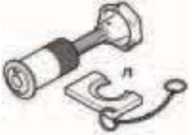
S306_071   | Outil de repositionnement et de dévissage pour piston dans l'étrier de frein          |
