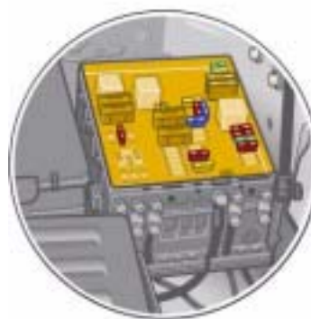
Boîtier électrique dans le compartiment moteur gauche
