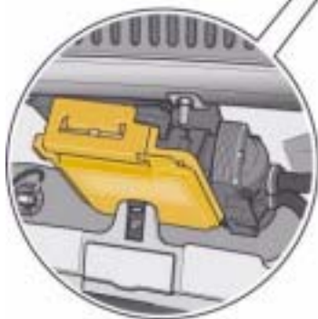
Appareil de commande pour Motronic J220 sous le cache du caisson d'eau
