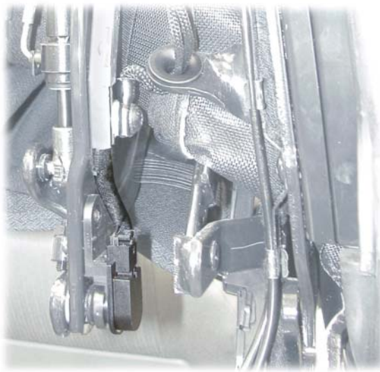
Capteur de position des brides de fixation de capote G356
