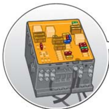
Boîtier électrique, à gauche dans le compartiment moteur
