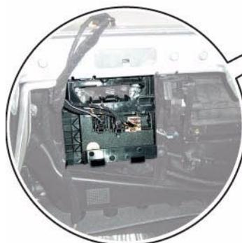
Calculateur central de système confort J393, à droite sous le tableau de bord, derrière la boîte à gants
