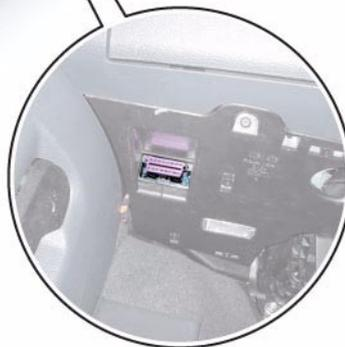
Connecteur 16 raccords, prise de diagnostic T16, à gauche sous le tableau de bord
