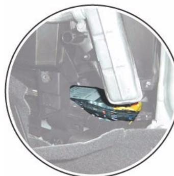
Calculateur de sac gonflable J234, sous la console centrale, sur le tunnel avant
