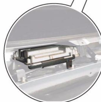
Calculateur pour Motronic J220, sous le cache du caisson d'eau
