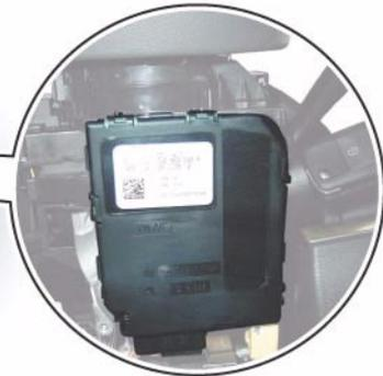
Calculateur d'électronique de colonne de direction J527, sous le commodo
