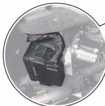
Calculateur d'ABS avec EDS J104, sur le tablier, à droite dans le compartiment-moteur
