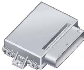
Calculateur de freins de parking et à main électriques J540 à gauche dans le coffre à bagages
