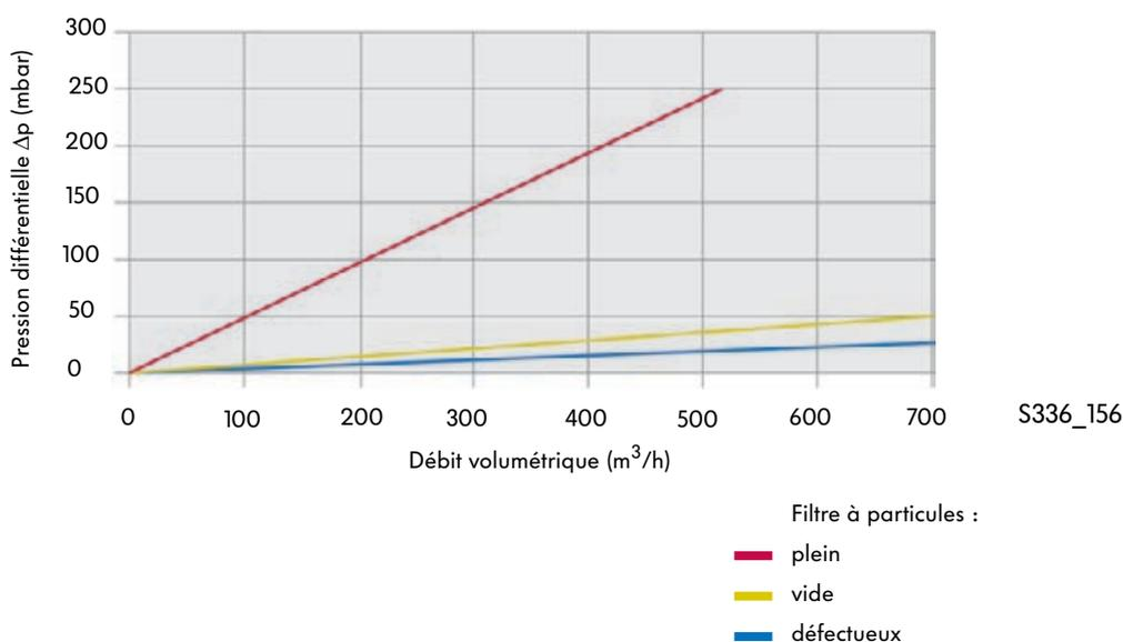
Le calculateur du moteur compare la pression différentielle avec le débit volumétrique des gaz d'échappement et obtient ainsi la résistance à l'écoulement du filtre à particules. La résistance à l'écoulement permet au calculateur du moteur de déterminer le niveau d'encrassement par la suie du filtre.
