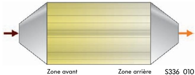
La zone avant est recouverte d'une quantité importante de platine. Dans la zone arrière, le platine n'est présent qu'en faible quantité.
