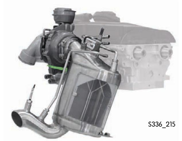
Le transmetteur de température en amont du turbocompresseur est un capteur CTP. Il est logé dans la ligne d'échappement en amont du turbocompresseur et mesure la température des gaz d'échappement à cet endroit.
