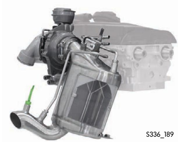
Il est logé dans la ligne d'échappement en aval du filtre à particules et mesure la température des gaz d'échappement à cet endroit.
