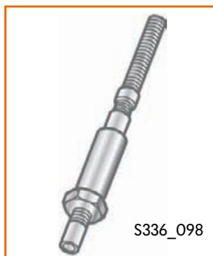
La sonde lambda est un modèle de sonde à large bande, située dans le collecteur d'échappement, en amont du catalyseur d'oxydation.
