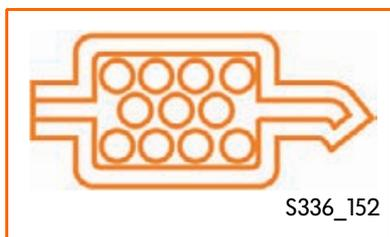
Le témoin de filtre à particules est situé sur le porte-instruments. Il s'allume lorsque le filtre à particules ne peut être régénéré en raison de déplacements de courte distance extrêmement fréquents.
