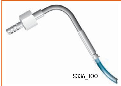
Le transmetteur de température en amont du filtre à particules est un capteur CTP. Dans le cas d'un capteur CTP (à coefficient de température positif), la résistance augmente lorsque la température augmente.
