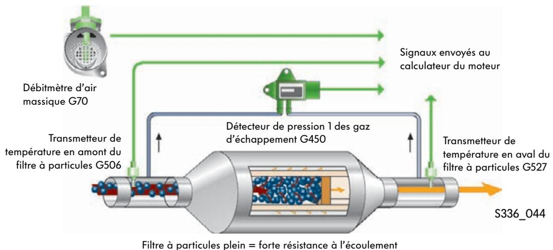
Le processus de régénération active est déclenché par le système de gestion moteur dès que le niveau d'accumulation de suie a atteint un seuil maximal.
