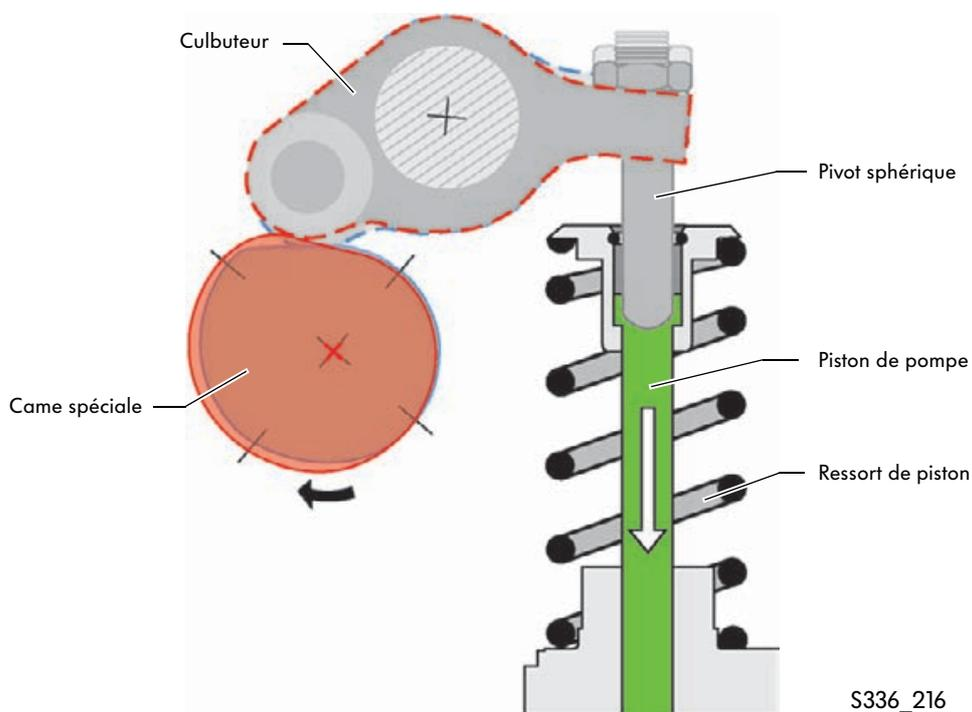
— Profil de la came sur les moteurs diesel avec système à injecteurs-pompes sans filtre à particules
