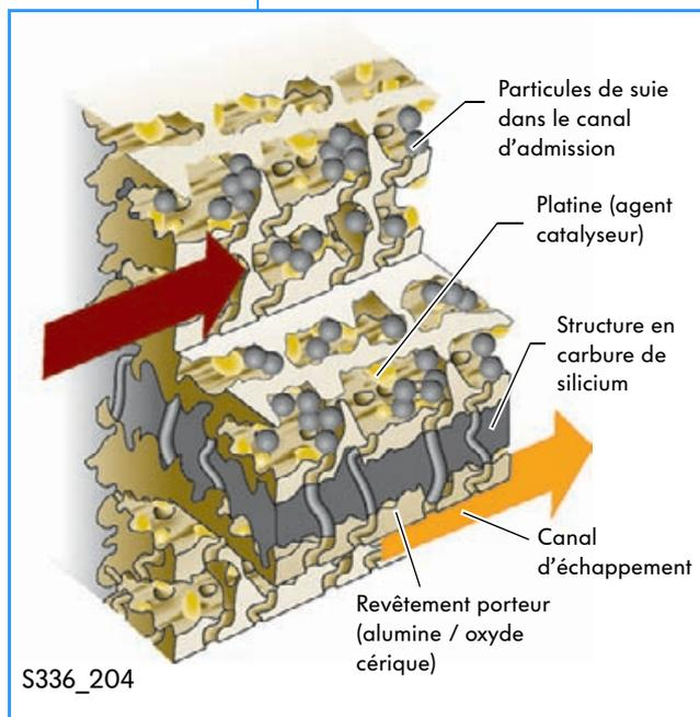
Composées de carbure de silicium, les parois du filtre sont poreuses. La structure en carbure de silicium est recouverte d'un mélange d'alumine et d'oxyde cérique.
