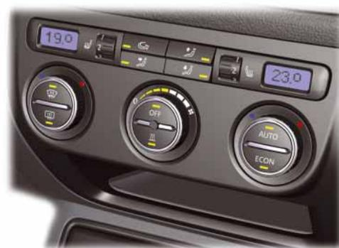
Tous les éléments de commande ayant un rapport avec la température et la ventilation ainsi que le calculateur du climatiseur sont intégrés dans l'élément de commande.
