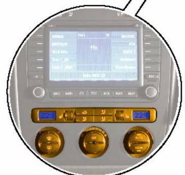
Calculateur de Climatronic J255, au centre du tableau de bord
