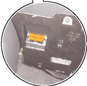
Prise de diagnostic T16 à gauche sous le tableau de bord, côté conducteur
