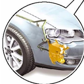
Calculateur de chauffage d'appoint J364, à droite dans le passage de roue
