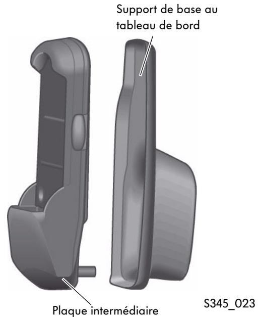
Un support spécifique au modèle de téléphone considéré est nécessaire pour pouvoir utiliser le téléphone portable avec le prééquipement.
