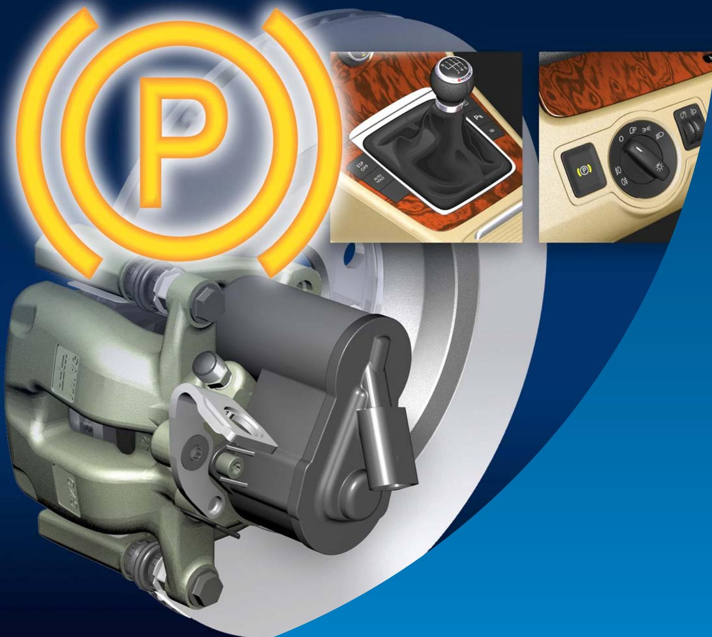
Pour immobiliser un véhicule à l'arrêt de façon vraiment sûre, il fallait jusqu'à présent que le conducteur tire fermement sur le levier de frein à main où qu'il appuie sur une pédale supplémentaire de frein de stationnement. A l'avenir, il suffira pour cela d'une courte pression sur une touche placée dans le tableau de bord – en effet, sur la nouvelle Passat, le frein de stationnement électromécanique remplace le frein de stationnement classique, à main.
