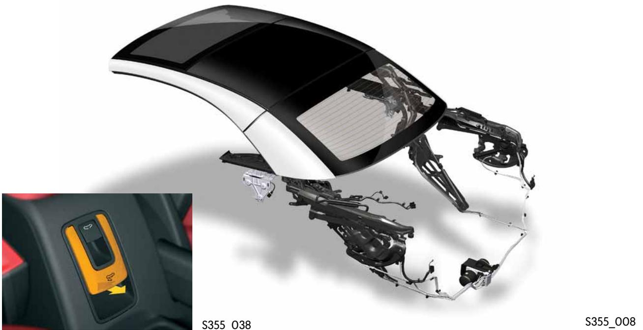
L'abréviation CSC signifie système de toit alliant les propriétés d'un toit coulissant d'un coupé à celles d'une capote de cabriolet. Il s'agit, ici, d'un toit rétractable en acier, à plusieurs éléments, qui représente une innovation technologique en raison de sa commande électrohydraulique sophistiquée.
