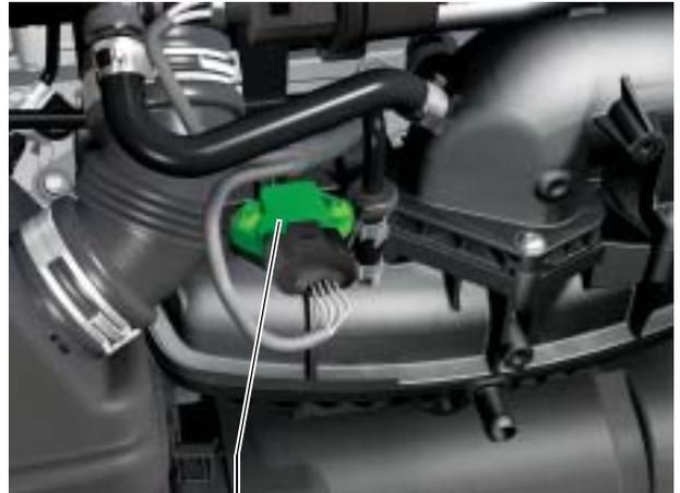
Transmetteur de pression de tubulure d'admission G71 avec transmetteur de température d'air d'admission G42 S359\_047
