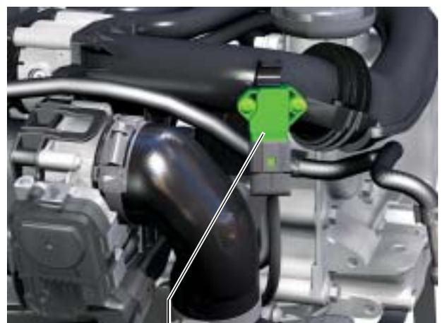
Transmetteur de pression de tubulure d'admission G583 avec transmetteur de température d'air d'admission G520 S359\_049
