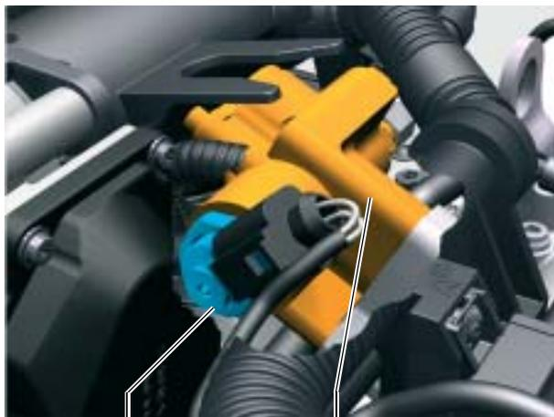
Vanne de régulation de pression de carburant N276      Pompe à carburant haute pression S359\_053
