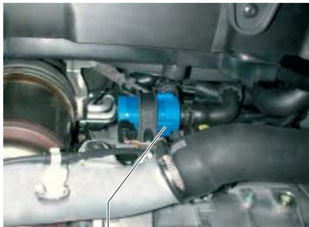
Pompe de recirculation du liquide de refroidissement V50
