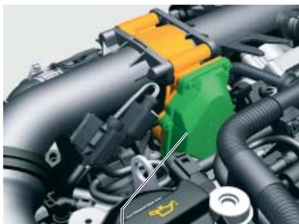
Unité de commande de volet de régulation J808 avec potentiomètre de volet de régulation G584 S359\_052
