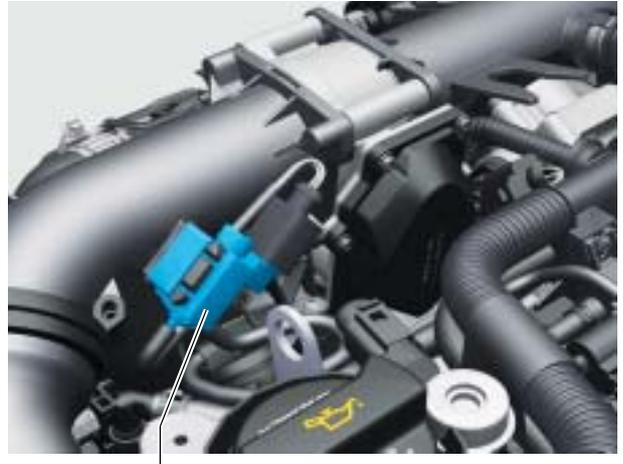
Vanne de volet de tubulure d'admission N316 S359\_051
