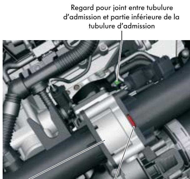
Regard pour joint entre tubulure d'admission et partie inférieure de la tubulure d'admission
