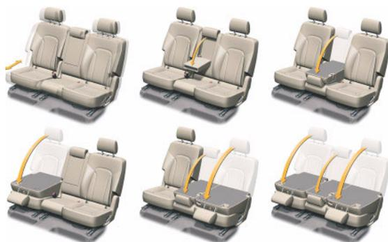
La fonction easy-entry de la deuxième rangée de sièges est commandée par un levier situé à côté de l'appuie-tête. Le dossier de siège est alors rabattu selon un angle donné vers l'avant. L'assise du siège est également déplacée dans le sens de la marche. La montée et la descente des passagers de la troisième rangée de sièges est rendue possible par la fonction easy-entry.
