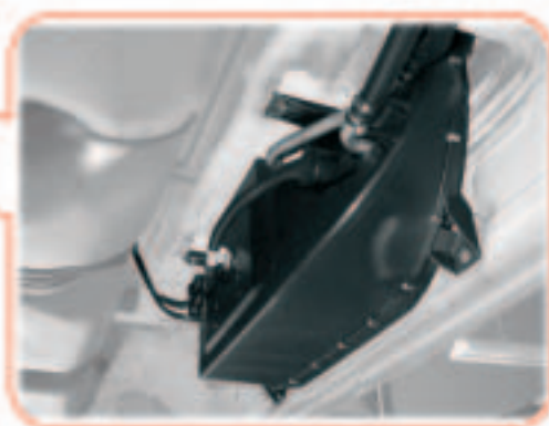
Échangeur de chaleur compartiment de charge/passager (avec soufflante) ; on peut également à cet endroit monter un chauffage stationnaire à circulation d'air chaud.
