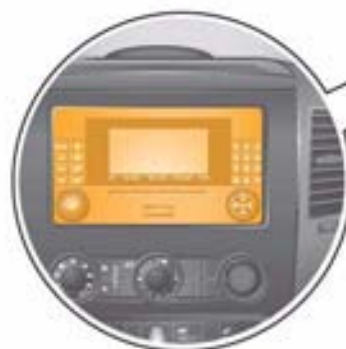
Calculateur avec unité d'affichage pour autoradio et système de navigation J503/Autoradio R, dans la zone centrale du tableau de bord
