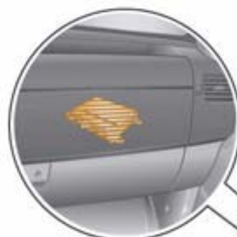
Calculateur d'électronique de commande du téléphone portable J412, derrière la boîte à gants
