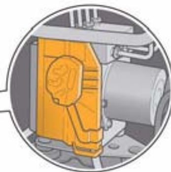
Calculateur d'ABS J104, à gauche dans le compartiment moteur
