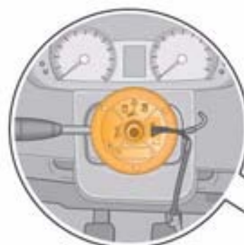
Calculateur d'électronique de colonne de direction J527, au niveau de la colonne de direction
