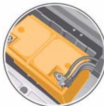
Porte-fusibles (SA), à droite au niveau de la batterie, visible uniquement après la dépose
