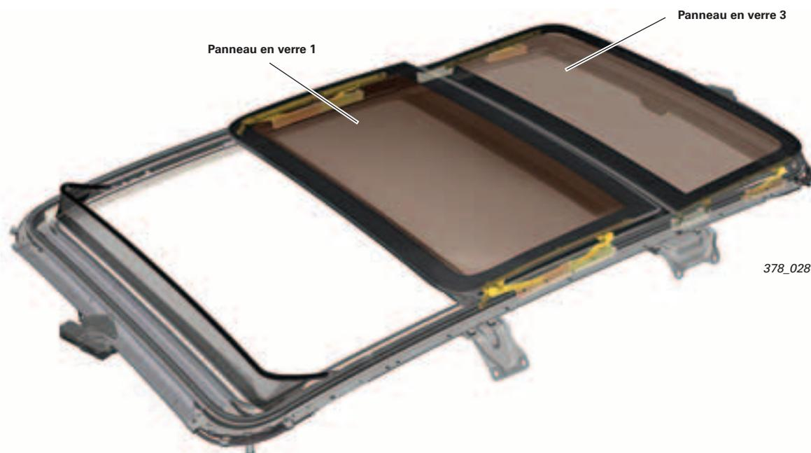
Pour ouvrir entièrement le panneau en verre 1, les guides extérieurs gauche et droit sont repoussés vers l'arrière et dépassent le panneau en verre 2. La fermeture du panneau en verre s'effectue dans le sens inverse de l'ouverture.
