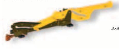
Lorsque le toit est fermé, les guides gauche et droit se trouvent en butée dans les glissières avant. Ils sont en position de repos.
