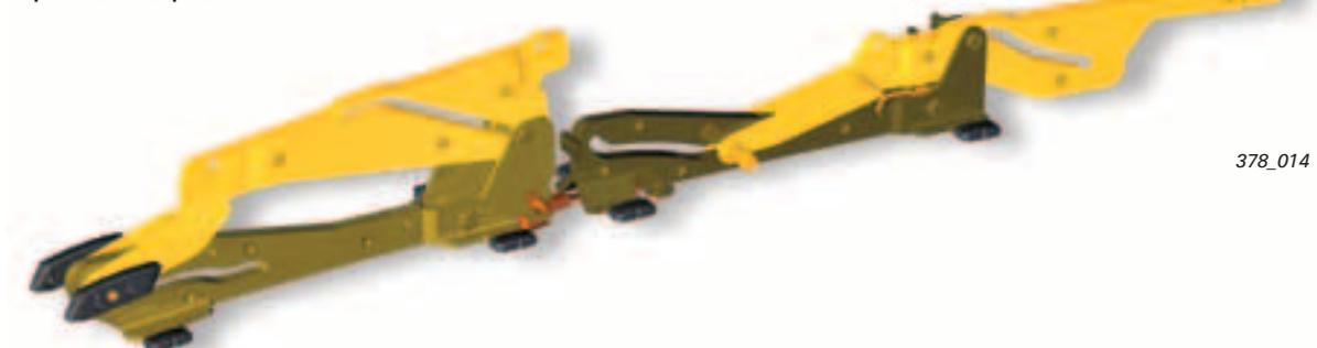
Le déverrouillage du guide du panneau en verre 3 est terminé ; le toit en verre 3 est relevé du fait de la géométrie du guidage de la coulisse dans le guide.
