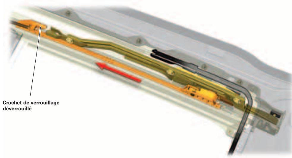
Lors de l'ouverture du panneau en verre, le guide est repoussé vers l'arrière. Simultanément, les pivots fixés sur les guides soulèvent le verrouillage avant et l'entraînent vers l'arrière. Après obtention d'une course d'environ 17 mm, le crochet de verrouillage arrière libère la coulisse. Le guide, qui poursuit sa course vers l'arrière, soulève la coulisse en raison de la forme du guidage de la coulisse et relève le panneau en verre.
