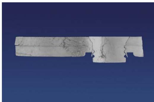
Représentation micrographique d'un assemblage par rivetage-perçage 383\_073
