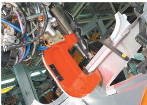
Processus de rivetage-perçage en production 383\_061
