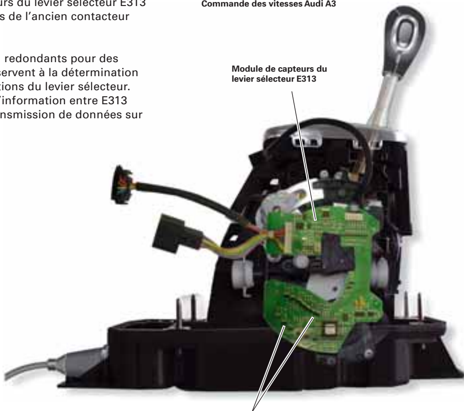
Capteurs de Hall pour détermination des positions du levier sélecteur P, R, N, D et S
