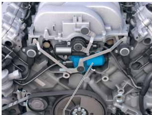
Moteur de volet de tubulure d'admission V157
