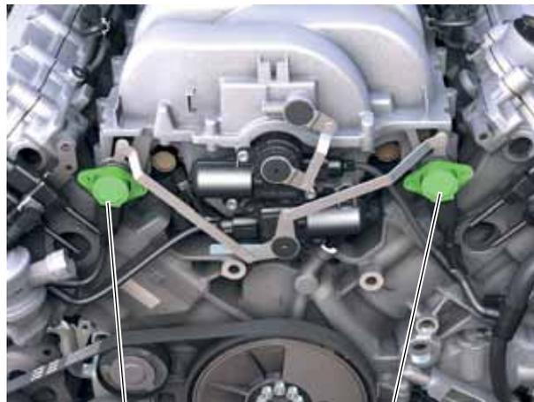
Potentiomètre de volet de tubulure d'adm. G336
