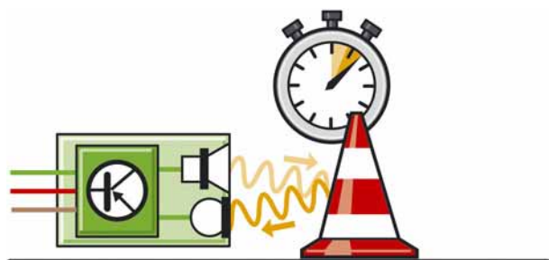
Le résultat de la mesure du temps de propagation est une mesure directe de l'écart existant entre le capteur et l'objet à mesurer. S389_051
