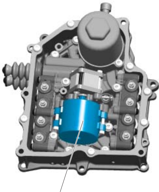
Moteur de pompe hydraulique V401
