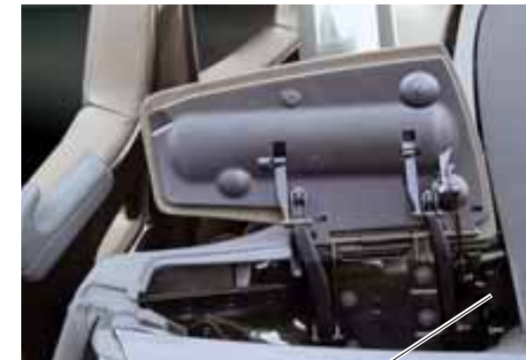
Moteur de volet de capote V383 avec capteur de volet de capote G596
