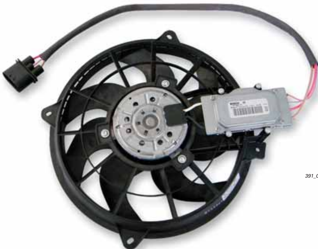
Ventilateur de radiateur V7 avec calculateur de ventilateur de radiateur J293
