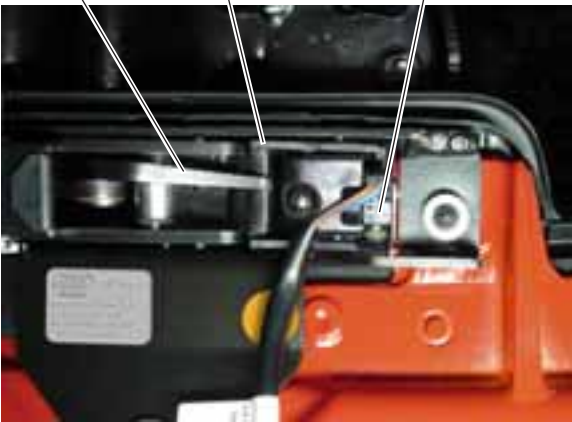
Crochets de sécurité Basculeur Contacteur de verrouillage avant de capote F172
