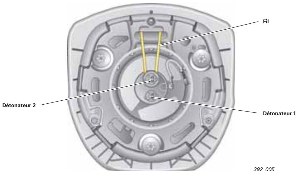
Tant que le fil est maintenu par le détonateur, l'orifice de refoulement est fermé.
