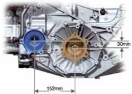
Silhouettes de l'Audi A4 (8E) (en gris) et de l'Audi A5 (en bleu) superposées sur une même position d'essieu (moteur/boîte - 3,0l TDI/0B4)
