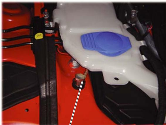
Boulon de masse dans le caisson d'eau
