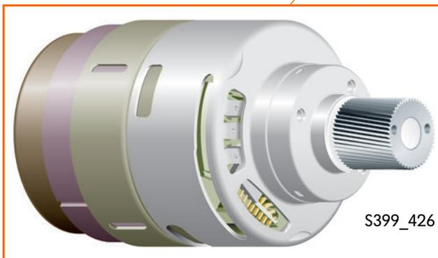
Le moteur de direction assistée électromécanique V187 est monté parallèlement à la crémaillère dans le carter de direction. Il transmet la force d'assistance de direction via une courroie crantée au mécanisme à écrou à circulation de billes.
