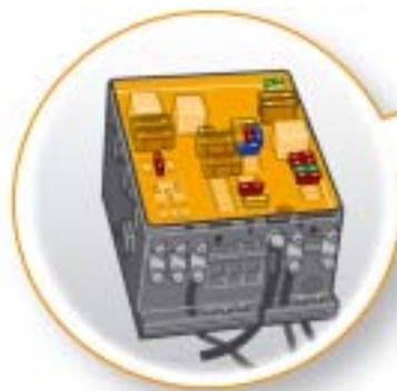
Boîte à fusibles ballast à gauche dans le compartiment-moteur
