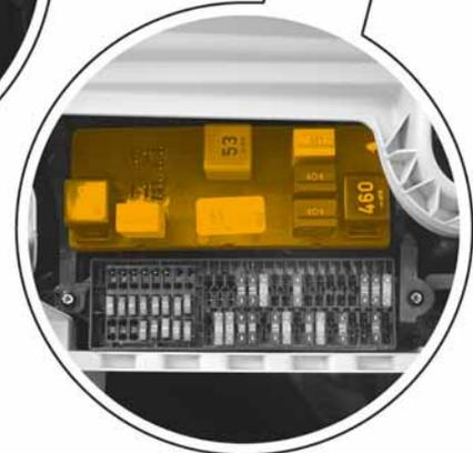
Porte-relais sur le calculateur de réseau de bord, à gauche sous le tableau de bord
