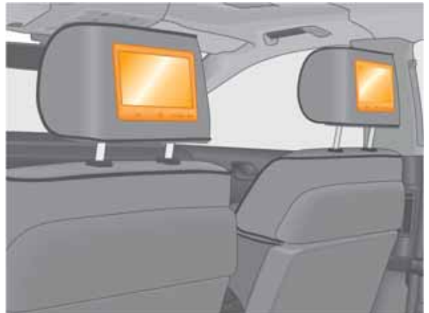
Emplacements de montage des écrans Y22 (gauche) et Y23 (droit)
