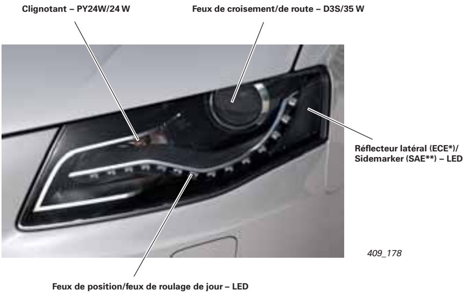
Disposition des feux sur la version bi-xénon et bi-xénon avec feux directionnels
