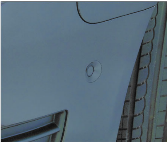
Emplacement de montage du capteur à ultrasons d'assistant aux manoeuvres de stationnement latéral gauche
