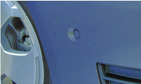
Emplacement de montage du capteur à ultrasons d'assistant aux manoeuvres de stationnement latéral droit
