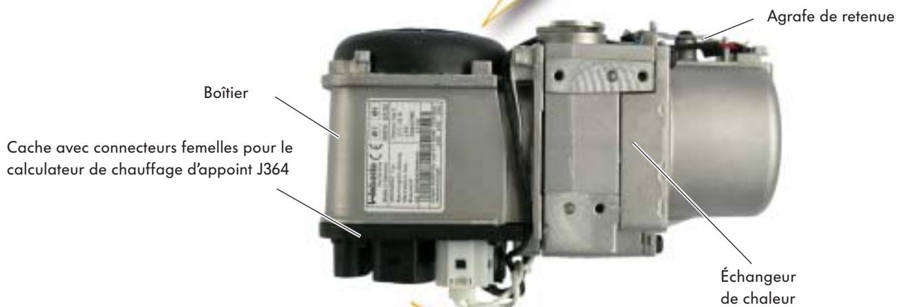
Le calculateur de chauffage d'appoint J364 se compose d'un cache doté de connecteurs femelles et d'une carte à circuit imprimé qui est intégrée dans le boîtier à côté du moteur de soufflante de manière à être protégée de l'humidité.
