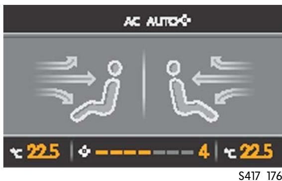
En plus, l'afficheur de l'autoradio ou du système de radionavigation fournit des informations du système Climatronic. Il apparaît par ex. l'affichage de température lorsque l'on règle la température souhaitée comme menu déroulant.
