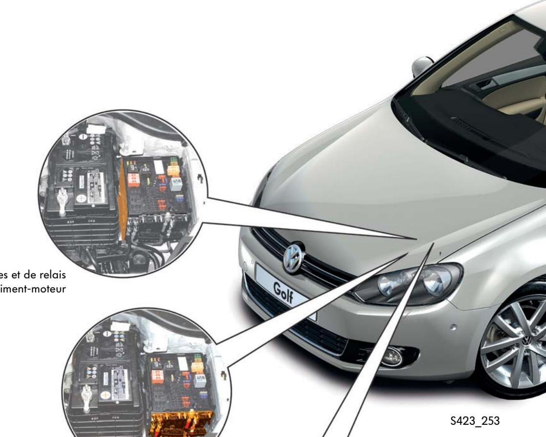
Boîtier de fusibles et de relais à gauche dans le compartiment-moteur
