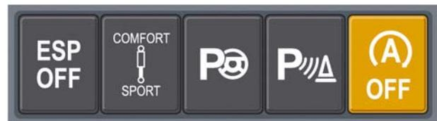
La touche de mode start-stop F416 remplace le bouton pour la régulation adaptative du châssis DCC
