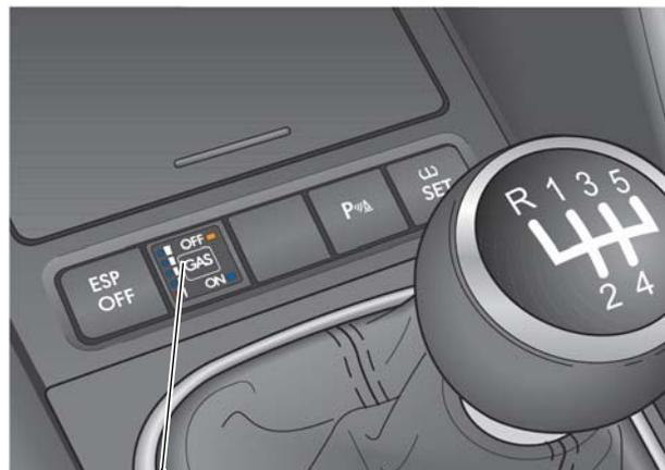
Touche de commutation avec indicateur de niveau de gaz G706 et commande de sélection du carburant E395 S427\_140
