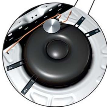
Touche de commutation avec indicateur de niveau de gaz G706 et commande de sélection de carburant E395
