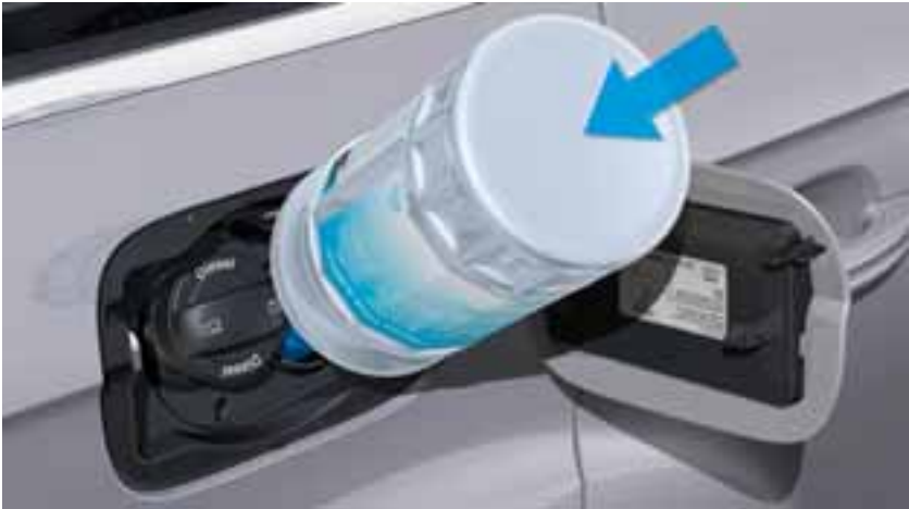
Pour ouvrir, enfoncer le bidon d'appoint d'AdBlue® et pour fermer, l'extraire.
