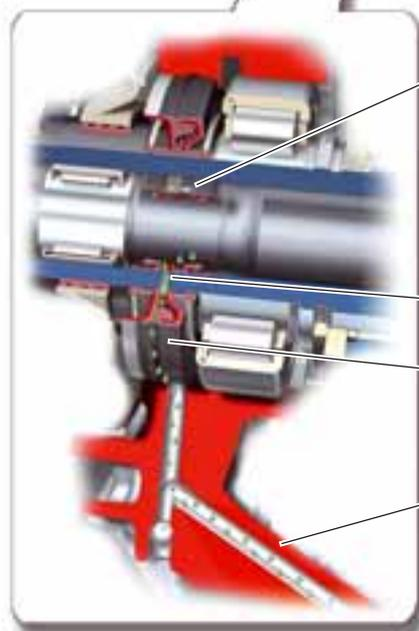
Double bague d'étanchéité d'arbre d'entrée 1
