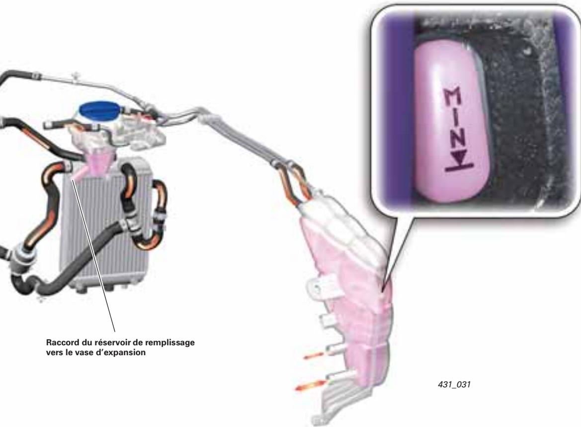
Raccord du réservoir de remplissage vers le vase d'expansion
