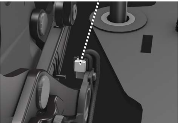
Sur la figure, le couvercle de logement de capote est représenté en position fermée (contacteur non actionné).
