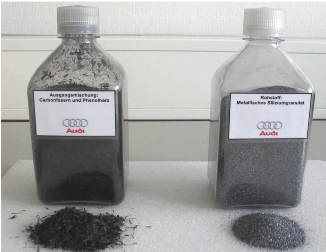
Matériaux initiaux : mélange de fibres de carbone, de résine phénol et de granulat de silicium
