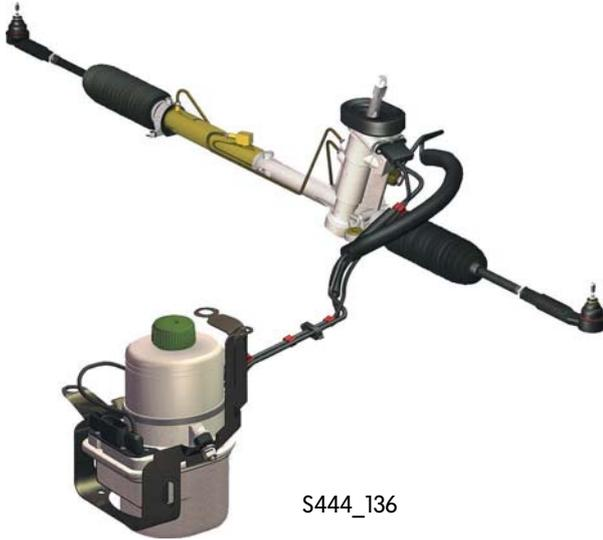
Comme son prédécesseur, la Polo 2010 est équipée d'une direction assistée électro-hydraulique. Celle-ci a été adaptée au nouvel essieu avant.
