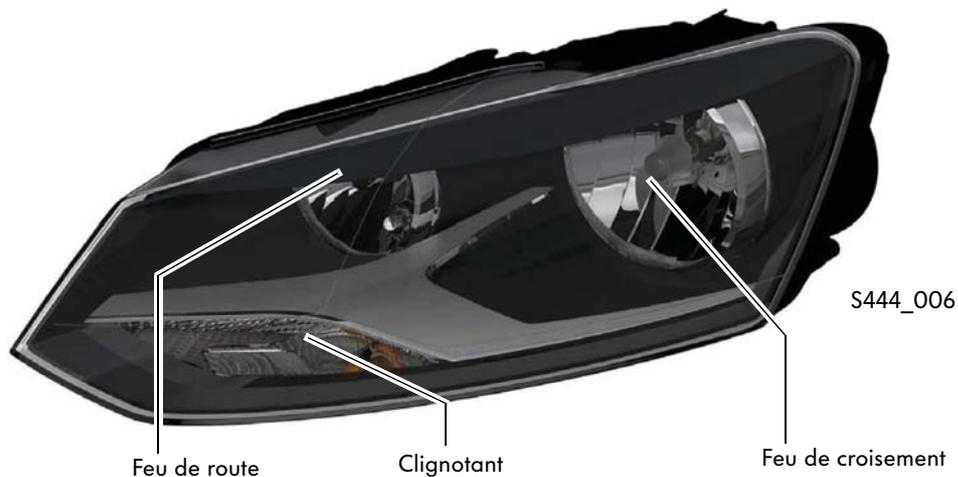
Les projecteurs de la Polo 2010 peuvent être démontés à l'aide de l'outillage de bord. Cette caractéristique est nécessaire, car les ampoules ne peuvent être remplacées que lorsque le projecteur est déposé. L'équipement de série comprend un projecteur H4. Un projecteur H7, avec des réflecteurs séparés pour le feu de croisement et le feu de route, est disponible en option. A partir de la finition Confort, le projecteur H7 est de série.
