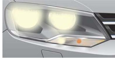
Quand les feux de route sont activés, c'est l'ampoule du feu de route, l'ampoule du feu de croisement, et l'ampoule de feu de position qui s'allument.
