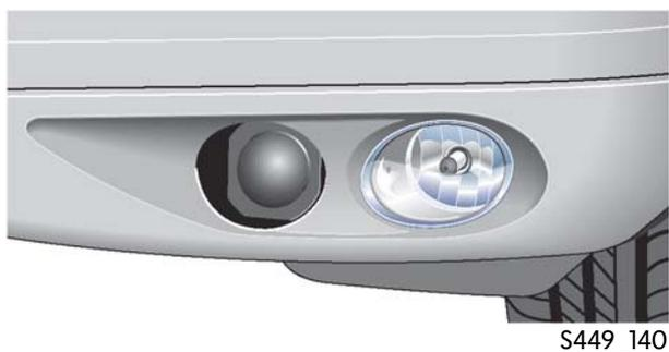
Le phare antibrouillard avec feu de braquage est implanté dans le spoiler. Le remplacement du phare antibrouillard s'effectue par une trappe située dans la coquille de passage de roue.
