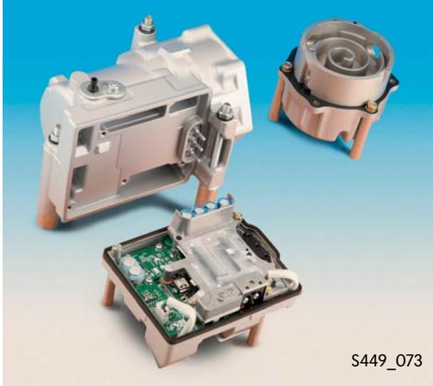
Par sa connexion au réseau haute tension, le compresseur de climatiseur électrique peut fonctionner même lors de l'arrêt du moteur à combustion. Si la charge de la batterie haute tension retombe alors en dessous d'un seuil défini, le système lancera automatiquement le moteur à combustion.
