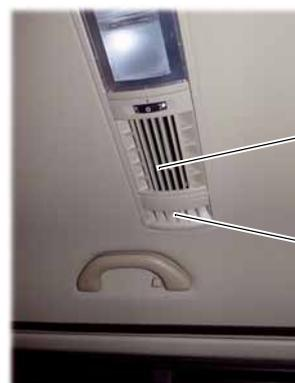
Diffuseur dans le ciel de pavillon pour climatisation de l'air ambiant
