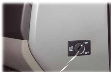
Commande à clé pour désactivation de l'airbag du passager avant E224
