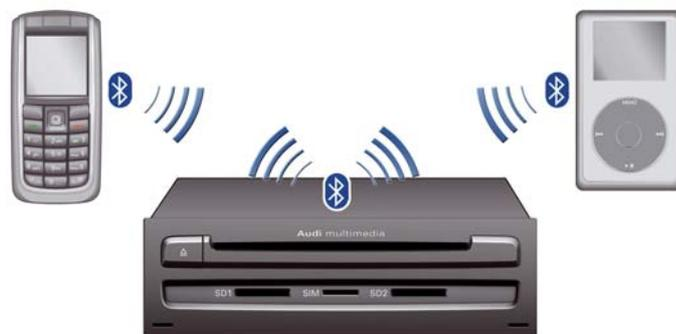
Connexion parallèle Bluetooth des deux terminaux avec J794
