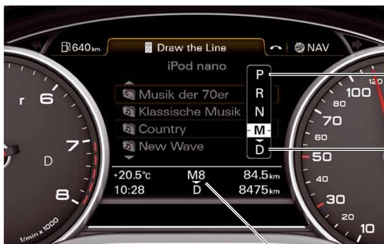
Ouverture pendant 5 s d'une fenêtre représentant la grille des rapports lorsque l'on actionne le levier sélecteur ou la touche de déverrouillage
