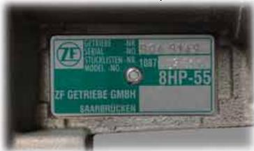
La plaque du constructeur se trouve sous l'arbre à flasque (visible de dessous)
