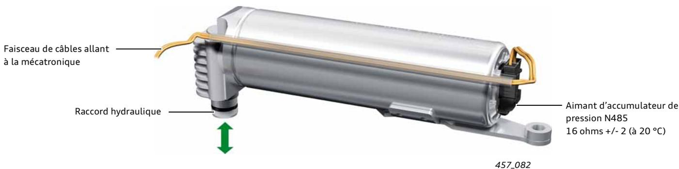
L'accumulateur de pression hydraulique à impulsions présente un volume utile d'env. 100 cm<sup>3</sup>.
