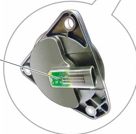
Le transmetteur de Hall de boîte transfert G759 est vissé dans le carter arrière de la boîte transfert. En raison des 3 vis de fixation asymétriques, d'un ergot de codage et de la position asymétrique de la languette d'entraînement, une rotation du transmetteur de Hall lors de son montage est impossible.
