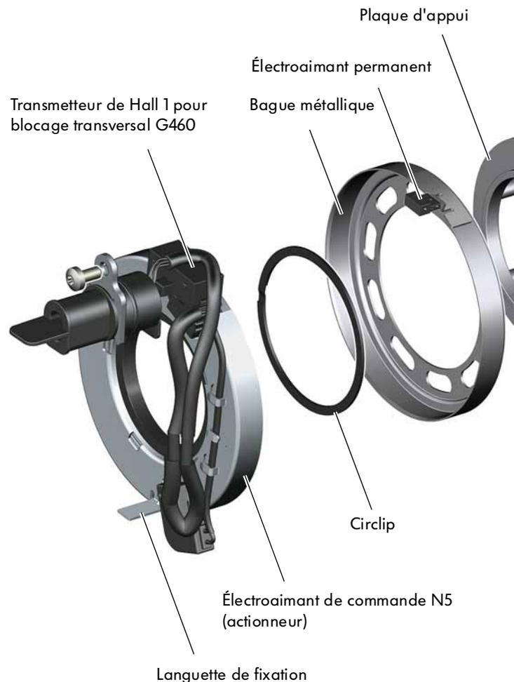
Le transmetteur de Hall 1 de blocage transversal G460 est monté sur l'électroaimant de commande N5 (actionneur).
