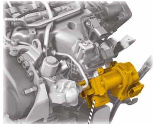
Unité de commande de papillon J338 avec potentiomètre de papillon G59
