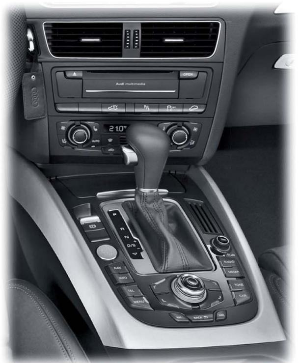
Commande pour mode EV et commande des vitesses avec fonction tip-S
