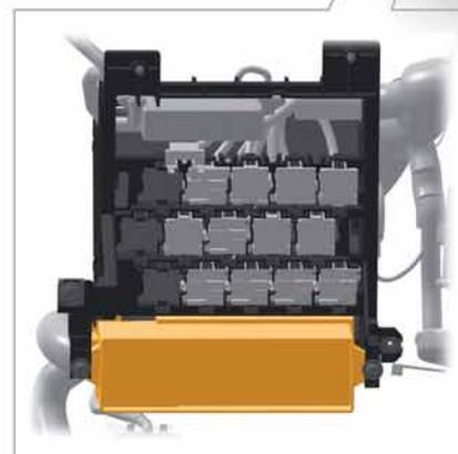
Porte-fusibles sur la face avant du boîtier en matière plastique – en bas
