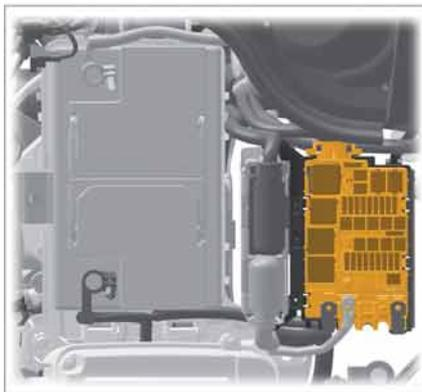
Boîtier électrique dans le compartiment-moteur à gauche, à côté de la batterie
